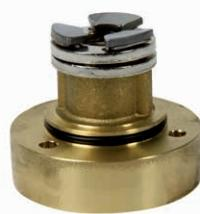
Gruppo reggispinga di tipo Kingsbury composto da ralla in carbonio e pattini oscillanti in acciaio inox ad altissima resistenza lavorati da Tesla con processo di lappatura sferica. Da 0,5 HP a 1 HP: 2000 N.
