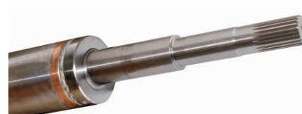
Albero rotore in acciaio inossidabile con sporgenza albero secondo norme NEMA 8". Il rotore è in rame per tutte le taglie. Nella versione standard il motore è fornito con una tenuta meccanica di tipo ceramica/carbone. Su richiesta è disponibile la tenuta meccanica in carburo di silicio (SiC/SiC). Il motore può anche essere equipaggiato anche con una tenuta a labbro addizionale (IP 68).
