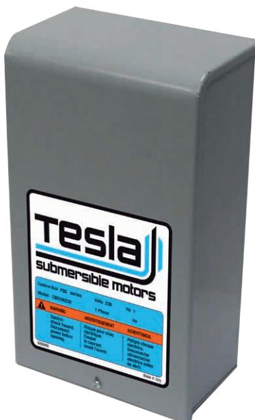
■ Protezione e comando di motore/pompa monofase con avviamento diretto. Scatola in materiale termoplastico antiurto e autoestinguente con due pressacavi. Interruttore generale bipolare luminoso presenza tensione. Alimentazione monofase 230 V +/- 5%. Potenze da 0.5 HP a 3 HP. Grado di protezione IP43. Condensatore di avviamento. Protettore termico con riarmo esterno manuale.
