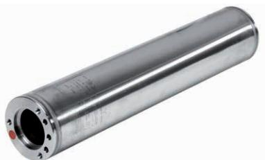
Stator incapsulated con camicia esterna in AISI 304. Lo stator è a 18 cave per una maggiore elasticità e regolarità di funzionamento; conduttori in rame isolato con doppio smalto in Classe F. Protettore termico incluso (versione monofase).
