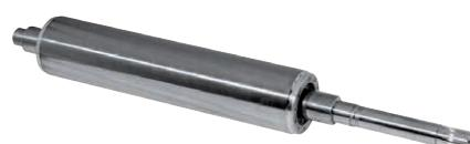
Statore riavvolgibile con camicia esterna in AISI 304L. Lo statore è a 24 cave per una maggiore elasticità e regolarità di funzionamento; conduttori in rame isolato con doppio smalto in Classe F.
