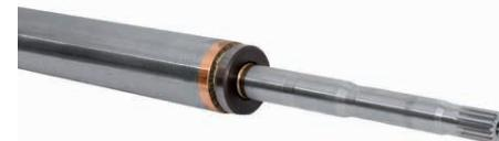
Lo statore è riavvolgibile, inserito in una camicia in acciaio inossidabile AISI 304 (su richiesta AISI 316 o 904). Nella versione standard l'avvolgimento è realizzato con filo di rame rivestito in PVC. Su richiesta è disponibile una versione con avvolgimento in PE2+PA che permette l'impiego del motore in speciali applicazioni e l'utilizzo con variatore di frequenza.
