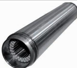
Lo statore è riavvolgibile, inserito in una camicia in acciaio inossidabile AISI 316 (su richiesta AISI 904). Nella versione standard l'avvolgimento è realizzato con filo di rame rivestito in PVC. Su richiesta è disponibile una versione con avvolgimento in PE2+PA che permette l'impiego del motore in speciali applicazioni e l'utilizzo con variatore di frequenza.
