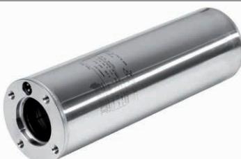
Statore incapsulato con camicia esterna e flange in AISI 304L. Lo statore è a 24 cave per una maggiore elasticità e regolarità di funzionamento; conduttori in rame isolato con doppio smalto in Classe F.
